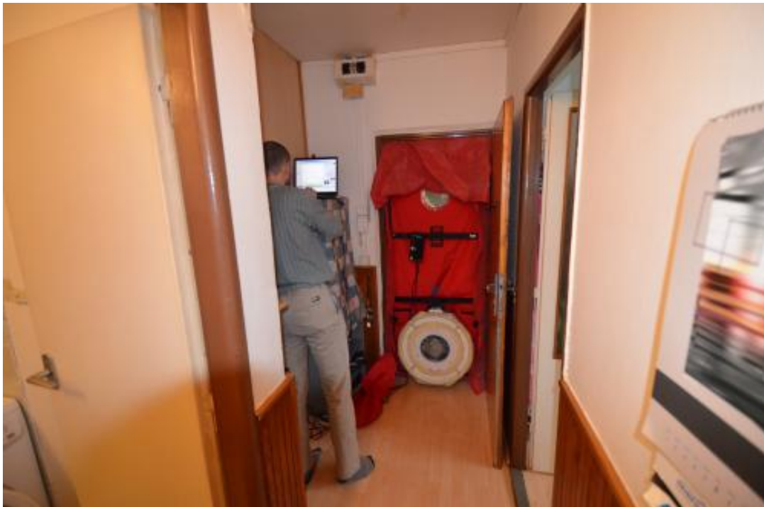
Obrázek 15 Blower door test
